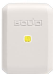
Блок разветвительно-изолирующий предназначен для использования в двухпроводной линии связи (в дальнейшем – ДПЛС) контроллеров «С2000-КДЛ», «С2000-КДЛ-2И», «С2000-КДЛ-2И исп.01», «С2000-КДЛ-2С» с целью изолирования короткозамкнутых участков с последующим автоматическим восстановлением после устранения короткого замыкания.
